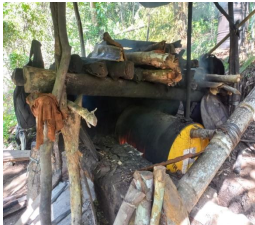
Gambar 2. Proses Memasak Captikus Dengan Menggunakan Tungku dan Belanganya Dari Drum Dimasak Dengan Api Besar.
